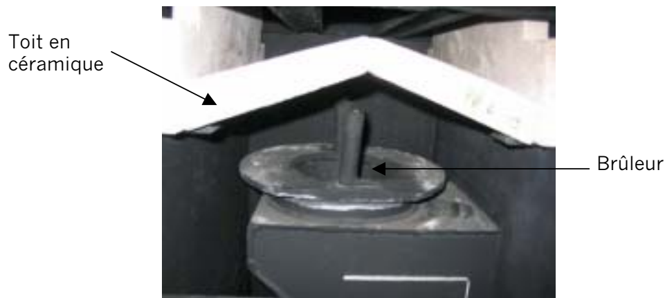
Photo 4 : Partie supérieure du brûleur en céramique
